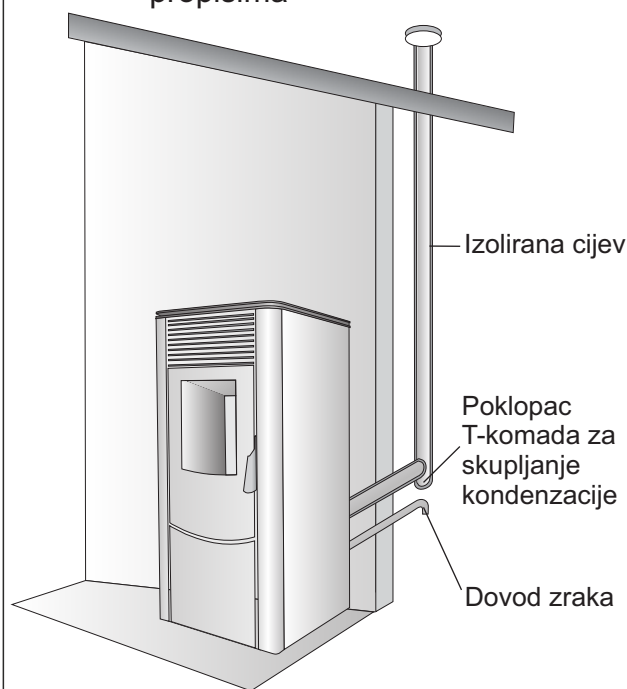
Slika 4. Vanjske dimovodne instalacije koje se moraju provesti u skladu s propisima
