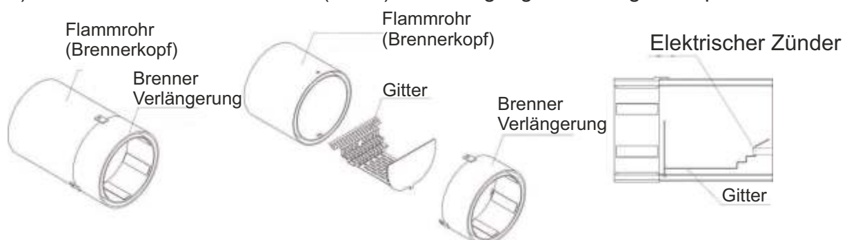
Bild b) Entfernen des Brennerrostes (Gitter) zur Reinigung und richtige Rostposition – CPPL-90
