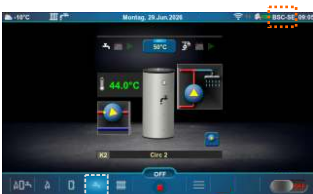
Bildschirm "Warmwasserspeicher" (WW) (BSC-SE)
