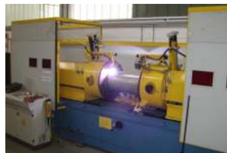
Automatsko zavarivanje bojlera od nehrđajućeg čelika
