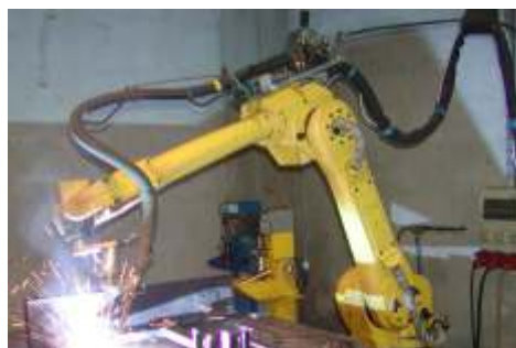
Robotsko zavarivanje kotlova
