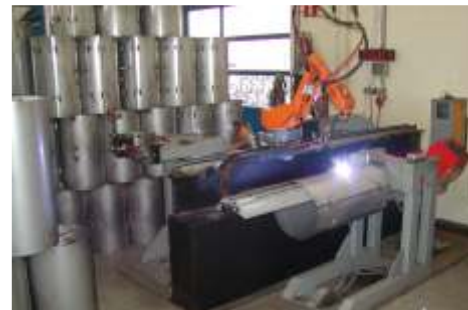
Robotsko zavarivanje bojlera od nehrđajućeg čelika
