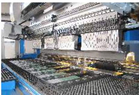
Savijanje lima suvremenim CNC upravljanim strojevima
