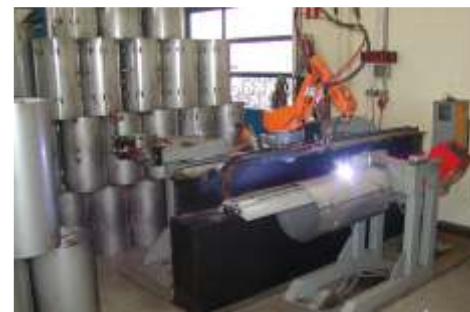
Robotsko zavarivanje bojlera od nehrđajućeg čelika
