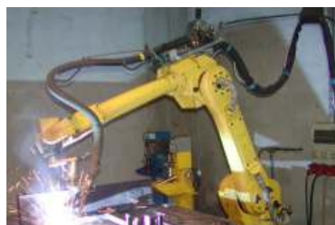
Robotsko zavarivanje kotlova
