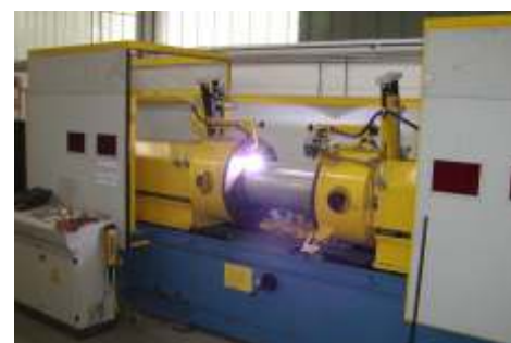
Automatsko zavarivanje bojlera od nehrđajućeg čelika
