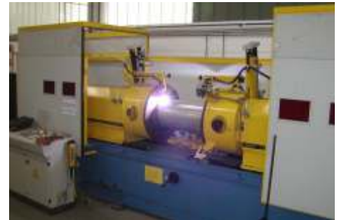
Automatsko zavarivanje bojlera od nehrđajućeg čelika
