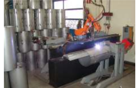
Robotsko zavarivanje bojlera od nehrđajućeg čelika
