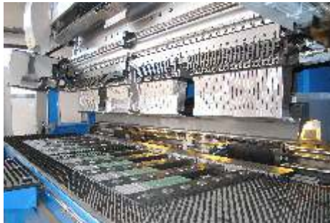
Savijanje lima suvremenim CNC upravljanim strojevima
